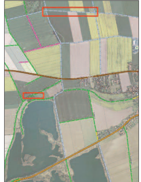
Kartenauszug: grün markiert - unbefestigte Wald- und Wiesenwege - und in grau Wege - für die keine bituminöse Befestigung erforderlich ist - Rot markiert zwei Beispiele zu gepflegten Wegeabschnitten.
